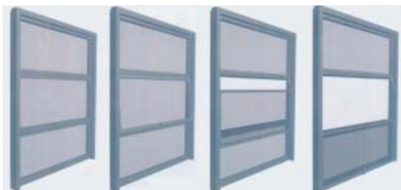
Blendrahmen eingebaut sind, werden die Flügel so justiert, dass diese in jeder Position stehen bleiben. Acht Sonderprofile kamen bei dieser Neuentwicklung zur Ausführung.
