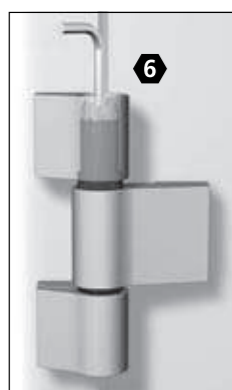
4. Lagerbuchse um \pm 90^\circ drehen bis sie spürbar einrastet (Dichtungs- andruck \pm 0,5 mm).
