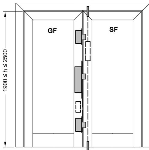
**Variante 4: Gangflügel: 3 Fallenriegelschloss Mehrfachverriegelung
