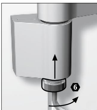
8. Hebespindel montieren
