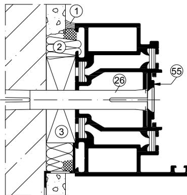
Oberer Wandanschluss bei Deckendurchbiegung
