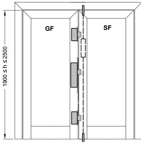
**Variante 5: Gangflügel: 3 Fallenriegelschloss Mehrfachverriegelung
