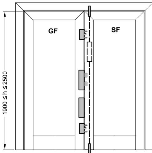
**Variante 3: Gangflügel: 3 Fallenriegelschloss Mehrfachverriegelung
