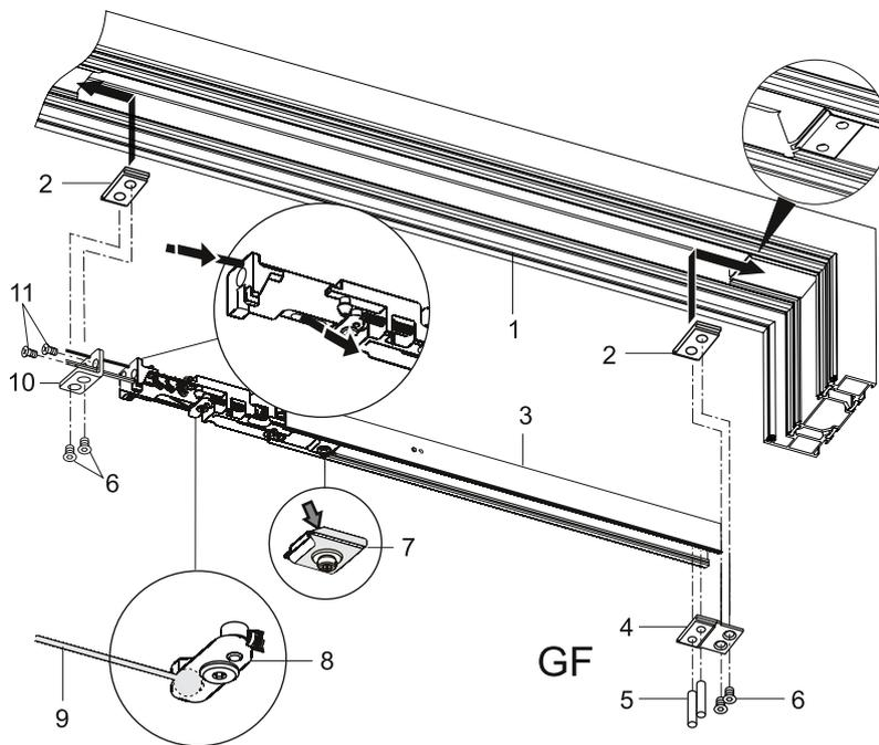
**Gleitschiene am Gangflügel montieren**
