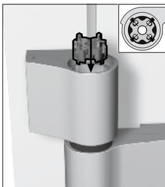
7. Verstellstern im oberen Rahmenbandteil positionieren
