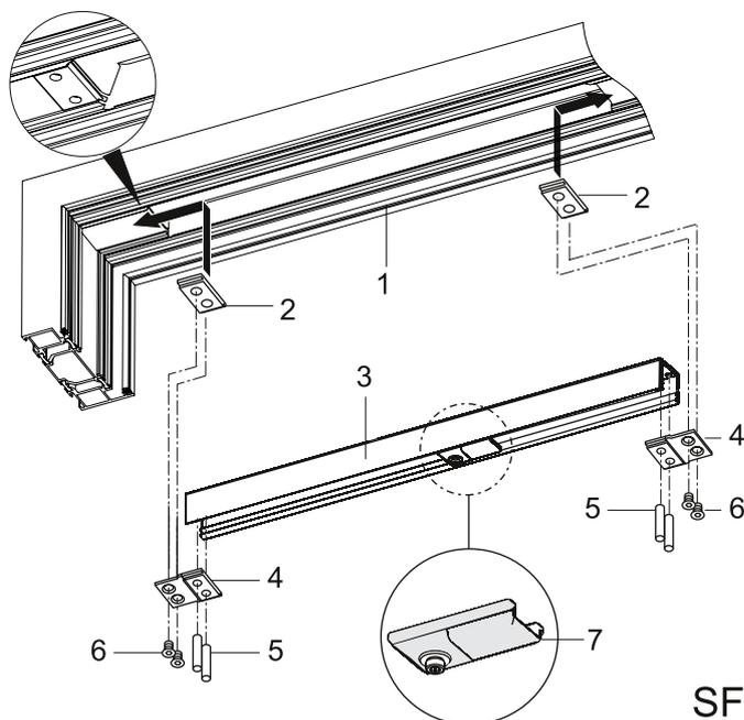
**Gleitschiene am Standflügel montieren**
