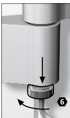
2. Hebespindel heraus-schrauben
