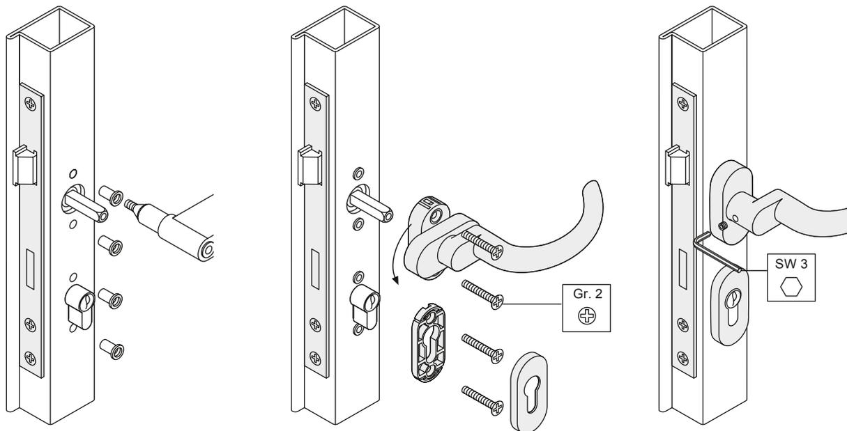
1. Die Einnietmuttern nach einander auf den Gewindedorn eines Nietwerkzeuges aufschrauben.
