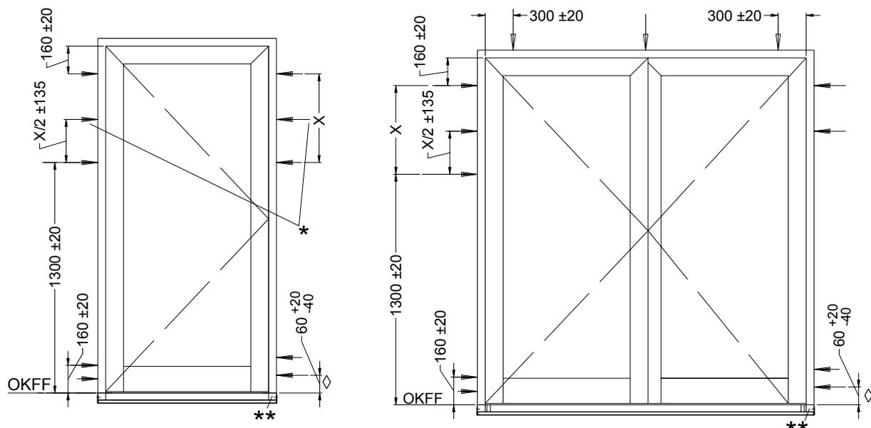
\* Zusätzlich Anker/Dübel bei  $X > 800$
