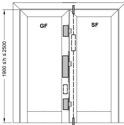
**Variante 2: Gangflügel: 7 Riegel-Fallenschloss - Motorschloss
