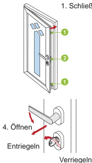
Diese Verriegelung weist zusätzlich Riegelfallen ① im oberen und unteren Bereich des Türflügels auf.
