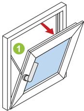
Die Zuschlagsicherung ① hemmt das selbständige Zuschlagen des gekippten Elementflügels. Dadurch wird eine Beschädigung des Elementes durch heftiges Auf- oder Zuschlagen des Flügels bei Zugluft verhindert. Die Zuschlagsicherung ist wartungsfrei.
