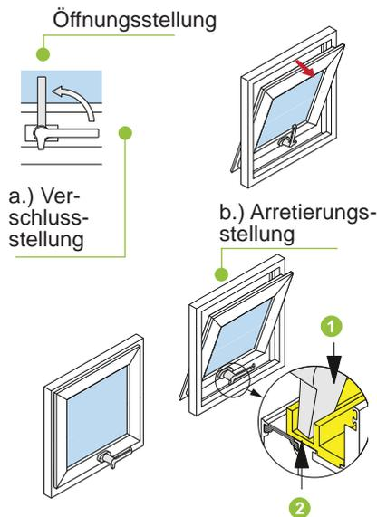
Die Drehlager der Schwingflügel-Fenster sind mit Bremsen ausgestattet, die das Element in geöffneter Stellung halten. Die waagerechte Stellung des Drehgriffes übernimmt zwei Funktionen.
