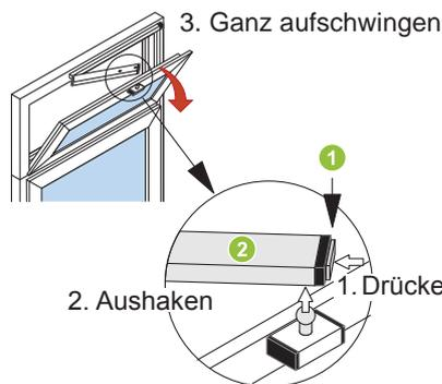
Um den Kippflügel ganz aufschwingen zu können (Putzstellung), muss der Oberlichtbeschlag ausgehakt werden.
