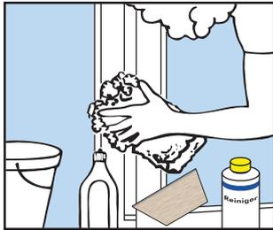
Die optimale Fensterpflege erreichen Sie, wenn Sie die Fensterrahmen und Dichtungen bei jeder Scheibenwäsche reinigen. Verwenden Sie hierzu ein mildes, scheuermittelfreies Reinigungsmittel.
