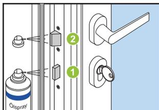
Bei Türen muss der Riegel ① und die Falle ② des Türschlosses den Anforderungen entsprechend gefettet werden.
