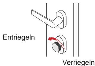
Dieser Schließzylinder wird im Außenbereich über einen Schlüssel und im Innenbereich über einen Schließknauf betätigt.
