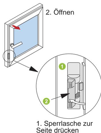
Der aufliegend angebrachte Spaltlüfter **1** begrenzt die Dreh- und Kippstellung des Elementflügels auf eine Spaltöffnung.
