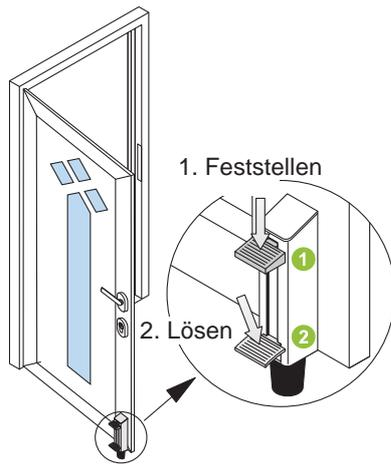
Mit dem Türfeststeller kann der Türflügel in geöffneter Stellung festgesetzt werden.
