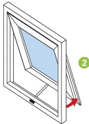
**2** Motorbetätigung mit verdeckt liegenden Schüco TipTronic Motoren für Verriegelung und Ausstellen
