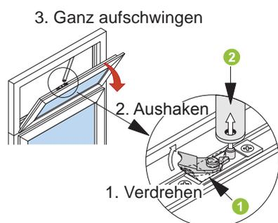
Um den Kippflügel ganz aufschwingen zu können (Putzstellung), muss der Oberlichtbeschlag ausgehakt werden.
